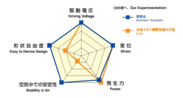
開発品は、数 V 程度と従来のイオン導電性高分子型 (IPMC) と同程度の低い電圧での駆動が可能であり、またその曲率(変形) 発生力はほぼ同程度です。また空気中での安定性については、イオン導電性高分子型よりも大幅に改良されております。また、熱可塑性の高分子電解質を用いているため、各種形状への成形が容易であり、自由度が高いと考えられます。
