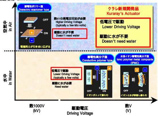
新規開発品は、当社保有のポリマー合成・設計技術、アロイ化技術により非水化、及びイオン伝導性・力学物性向上を図った新規高分子固体電解質、及び炭素材料設計技術により開発した大きな変位量を生み出す柔軟電極からなります。また上述の新規高分子固体電解質は熱可塑性 つであり、種々の形状への成形が容易です。図のように、電極間に電圧を印加することによって、高分子電解質中のイオンが移動し、マイナス極側が大きく膨らむことで全体がプラス極側に屈曲します。
